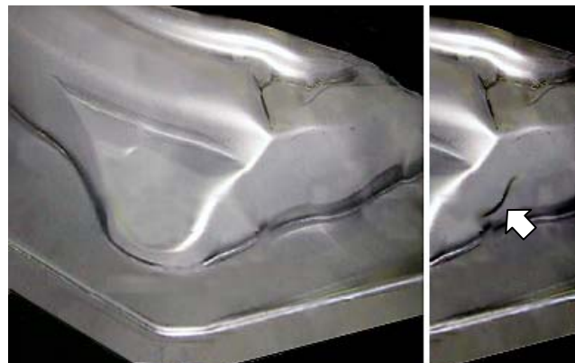
図4 金型絞り加工中に製品で発生した亀裂
